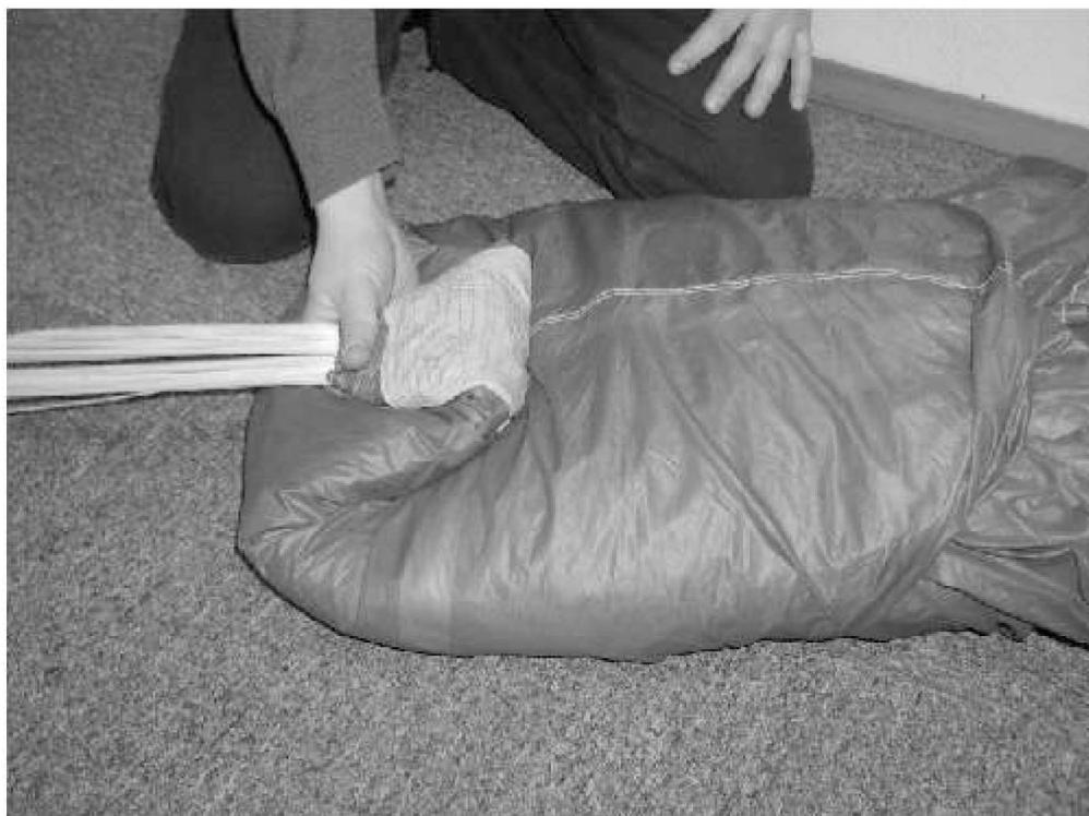
При безкамерной укладке купола в ранец,
