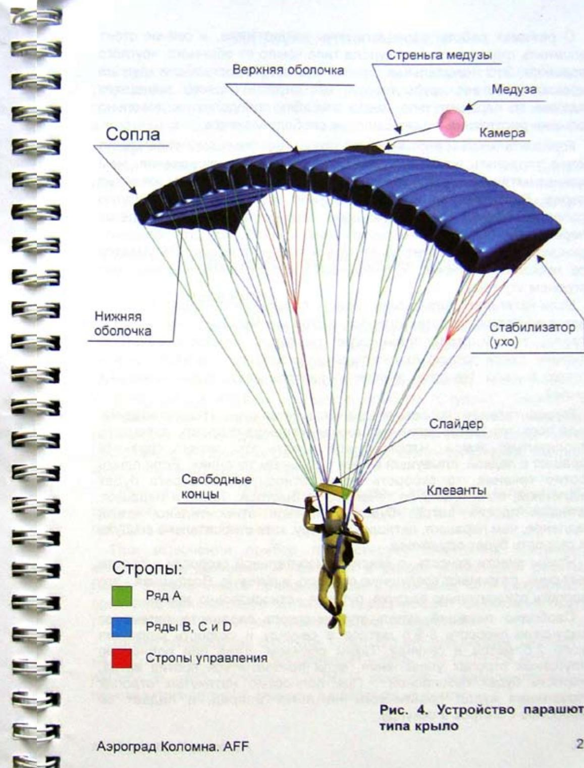
Рис. 4. Устройство парашюта типа крыло
